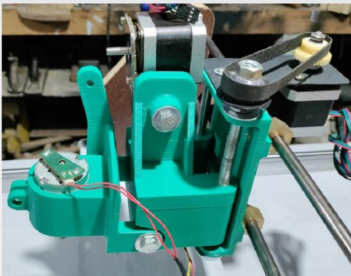
Figura 13. Muestra el montaje de los motores y la forma en que se acopla el motor del eje Z.
